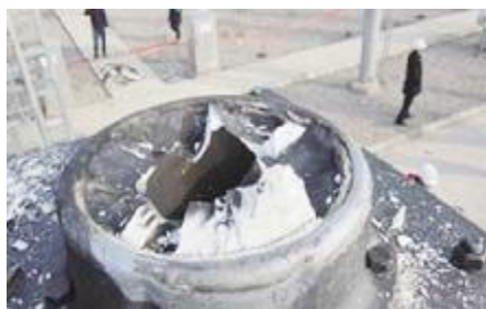
(b) B 相支持瓷瓶根部法兰过热痕迹
